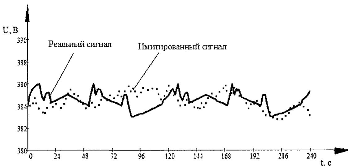
Рисунок 2.31 – Реальный и имитированный сигнал линейного напряжения электрической сети питающей лабораторную установку
